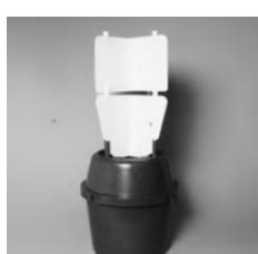
Die gekreuzten Fallenwände auf das untere Fallenkreuz stecken.
