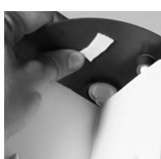
Den Schutzfilm des Klebestreifens auf der unteren Seite des Fallendeckels entfernen.
